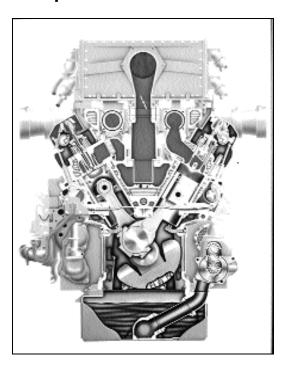
Se construye en una sola pieza de fundición gris. Después de su moldeado se le somete a un proceso de tensiones que proporciona su posterior invariabilidad dimensional e incremento del límite de rotura. Los cilindros se disponen en V con un ángulo de 60°; de esta forma, la anchura del bloque es mínima.
